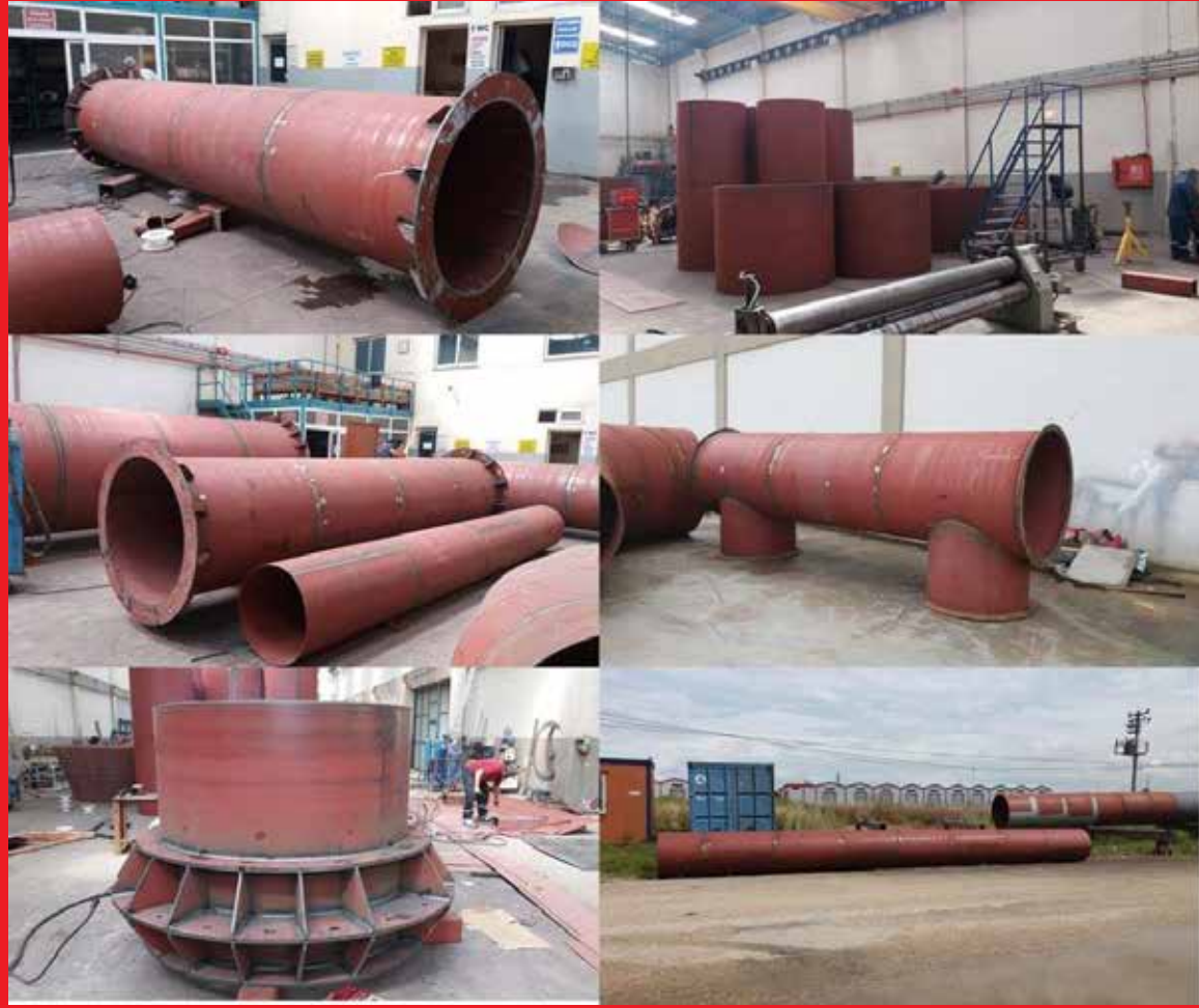
Demir Çelik Fabrikası Sıcak Gaz Borusu
